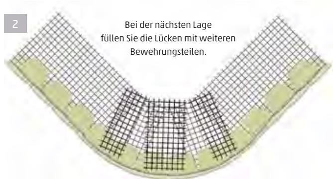
Wiederholen Sie diesen Vorgang beim Bau des Radius so oft, wie eine Bewehrung gebraucht wird.
