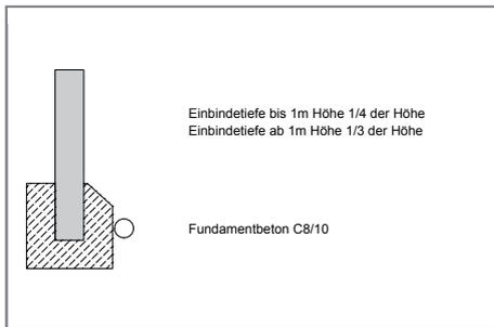
Bei Verwendung von Transportbeton den vorgesehenen Verzögerer beachten, damit der Beton verarbeitbar bleibt. Es ist erdfeuchter Beton zu verwenden, der durch stampfen verdichtet wird.
