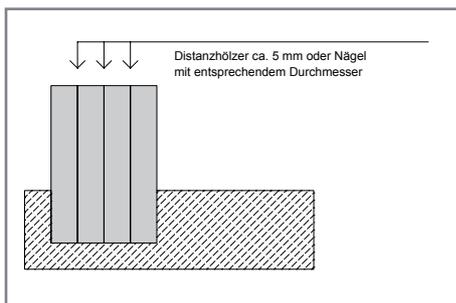
Zur Erzielung des notwendigen Abstands können Distanzhölzer oder Nägel mit entsprechendem Durchmesser verwendet werden. Nach dem Ansteifen des Betons können diese Hilfsmittel wieder entfernt werden.
