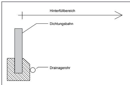
Zur Verhinderung von Frostschäden, die durch mangelhafte Entwässerung im Hinterfüllbereich entstehen, ist das Verlegen einer Drainage erforderlich. Das Einbringen einer Dichtungsbahn verhindert, daß Wasser auf der Sichtseite austreten kann.
