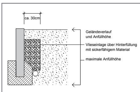
Der Hinterfüllbereich der Palisaden darf nur ebenerdig angefüllt werden. Belastungen durch Fahrzeugverkehr in diesem Bereich sind nicht zulässig.
